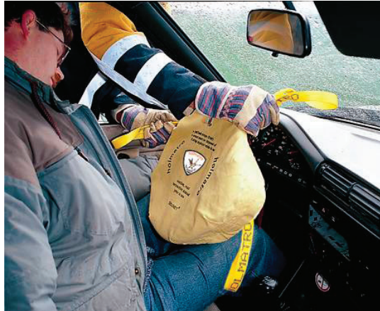
Figura 33: Aplicação das proteções dos airbags
