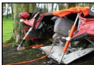
Figura 48: Macacos (permite afastar estruturas que se encontrem mais distantes como, por exemplo, afastar o tablier ou elevar o tejadilho).
