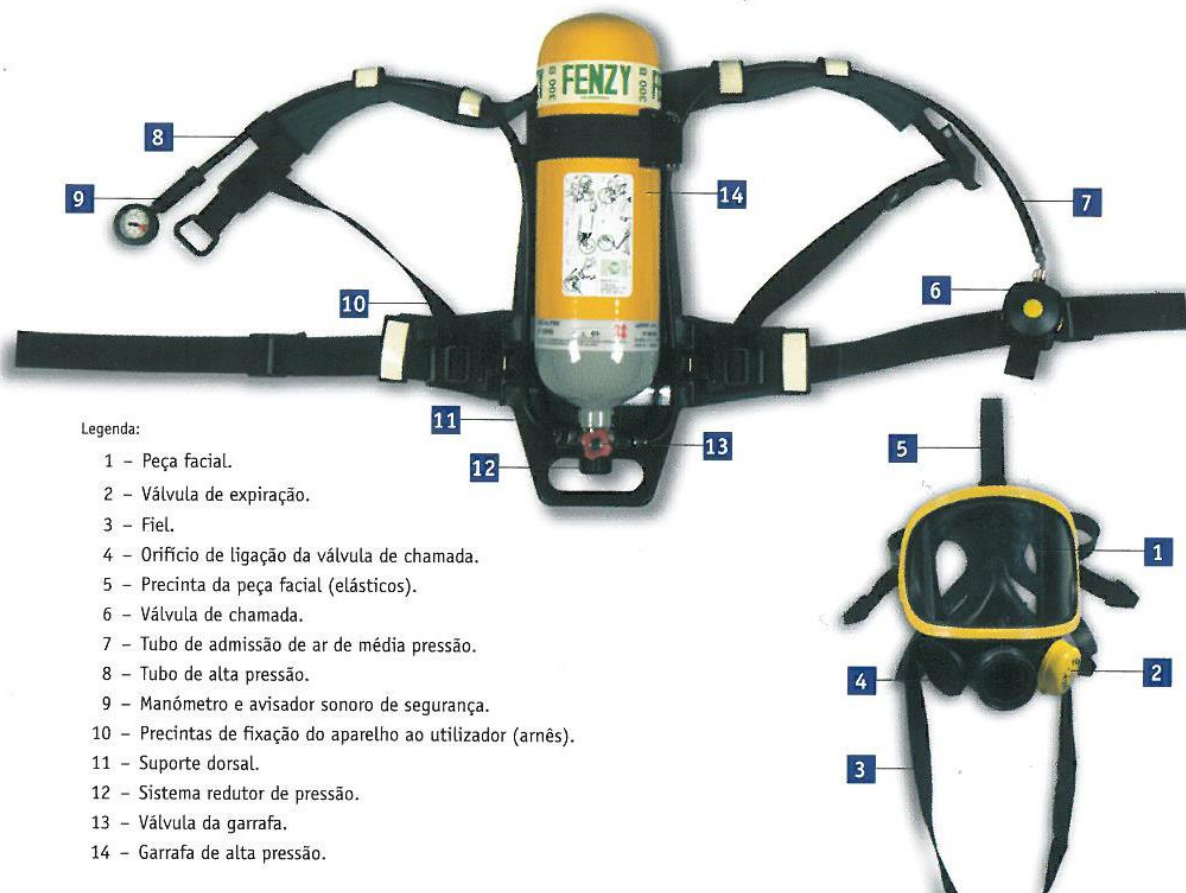
Figura n.º 2: Aparelho respiratório isolante de circuito aberto (ARICA).
