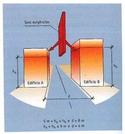
Figura n.º 4: Medidas para dificultar a propagação de incêndios entre edifícios. (*in* "Manual de Segurança Contra Incêndio em Edifícios", de Carlos Ferreira de Castro e José Barreira Abrantes)
