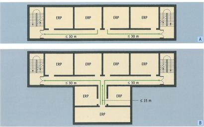
Figura n.º 8: Distâncias máxima até atingir uma saída: A - sem impasse, B - com impasse. (*in* "Manual de Segurança Contra Incêndio em Edifícios, de Carlos Ferreira de Castro e José Barreira Abrantes)
