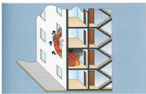
Figura n.º 3: Propagação do incêndio através da fachada de um edifício. (*in* "Manual de Segurança Contra Incêndio em Edifícios", de Carlos Ferreira de Castro e José Barreira Abrantes)
