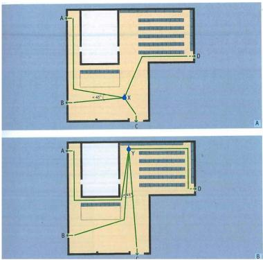
Figura n.º 7: Saídas de um estabelecimento comercial: A – no ponto X, as saídas A e B não são independentes; B – no ponto Y, as saídas A, B e C não são independentes. (*in* "Manual de Segurança Contra Incêndio em Edifícios, de Carlos Ferreira de Castro e José Barreira Abrantes)
