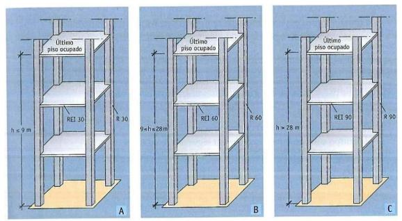
Figura n.º: Valores típicos de resistência ao fogo de elementos estruturais (A- Pequena altura, B – Média altura, C – Grande altura). (in "Manual de Segurança Contra Incêndio em Edifícios", de Carlos Ferreira de Castro e José Barreira Abrantes)
